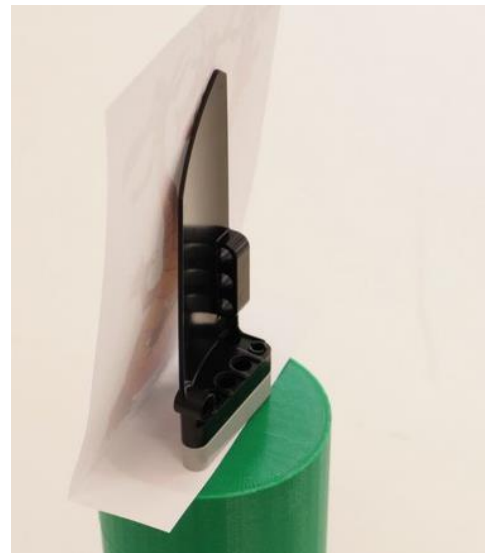
Пример установки фигурки с мишенью на цилиндре с фиксацией с помощью черного крыла
